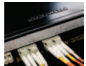
Панель FCP3-R-01 с четверным проходником LC
